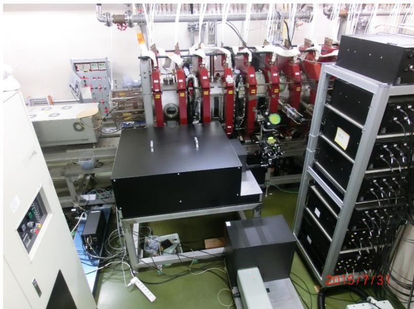
図 3. トムソン散乱システム導入後の PANTA 装置周辺写真。プローブレザーのレーザーヘッドは写真下。レーザーは暗箱を通り、PANTA 装置した側に設置されたミラーおよび集光レンズを通り、チャンバー中心軸上で集光され、その後チャンバー上側のビームダンプに導かれる。トムソン散乱光の一部は、PANTA チャンバー横の窓からレンズで受光され、分光器内に導かれた。
