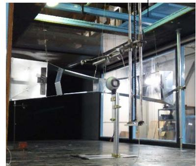
Fig. 3 トラバーサーと熱線流速計
