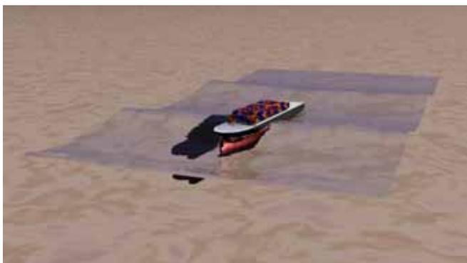
CIP法による波浪中船体運動の計算例
