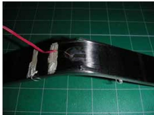
図4 試験片 の曲げ試験後の様子
